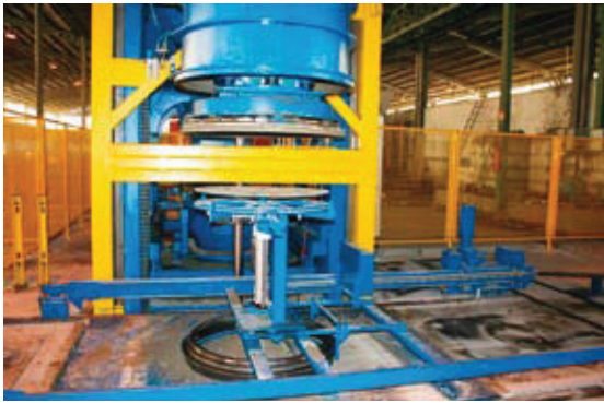
Fig. 2 Tornado with anchor machine Abb. 2 Tornado mit Ankerautomat
