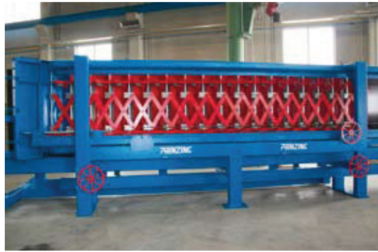
Fig. 3 Staircase formwork Sirius with quick change-over system Abb. 3 Treppenschalung Sirius mit Schnellverstellung
